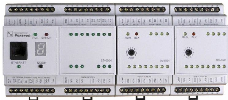
Obrázek 2.4: Programovatelný automat Tecomat Foxtrot
